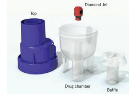
Samo srce Sidestream-a jeste unikatni mlazni sistem gdje se zrak i tekućina provlače kroz jedan otvor i drže razdvojenima. Koristeći Bernulijev princip, tečnost se povlači prema gore kroz posebne cijevi u mlaznjaku. Male čestice se zatim dijele ili kidaju od prisutne tečnosti pomoću dovedenog zraka proizvodeći partikule tako dobrog kvaliteta da je potrebna minimalna provjera neželjenih partikula.
